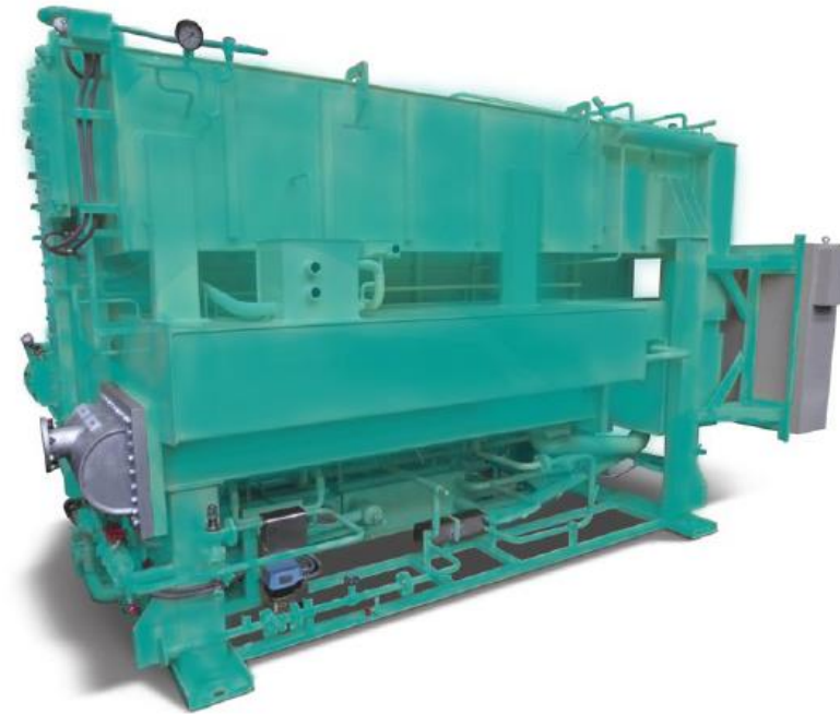
YHAP Absorbtionswärmepumpe Dampf, Gas oder Heißwasser- Antrieb / R718 Warmwasser bis zu 95°C Heizleistung: 900 bis 40000 kW
