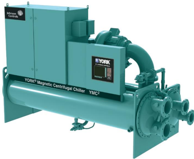
YMC2 Wasser-Wasser-WP magnetgelagerter Turboverdichter und VSD Antrieb, ölfrei / R513a Warmwasser bis zu 68°C Heizleistung: 1000 bis 3000 kW
